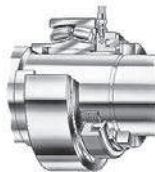
Figura 8. Porca HMV e anel de batente em posição para retirar a manga adaptadora
